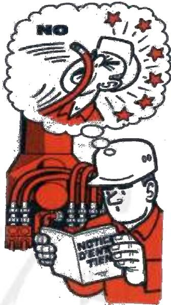
Antes de intervenir sobre el circuito hidráulico asegúrese de que el motor está parado, accione las palancas en ambos sentidos. Para despresurizar siga las indicaciones del fabricante. Tenga precaución de no quemarse con los aceites hidráulicos del equipo.
